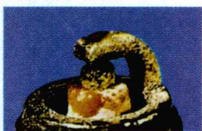
Considerable depósito de plomo, capa vitrificada
