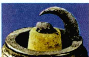
Considerable desgaste de los electrodos
