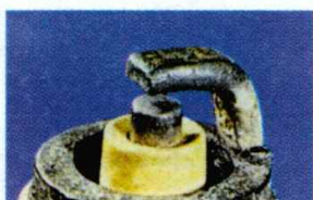
Ligero depósito de plomo
