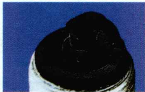
Cubierta de hollín
