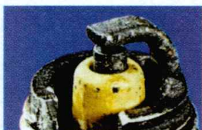
Considerable depósito de plomo, gruesa capa de amarillo
