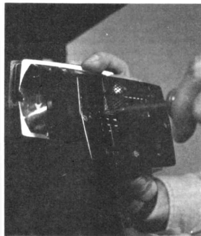
Fig. 33 Sustitución de lámpara en el piloto trasero
