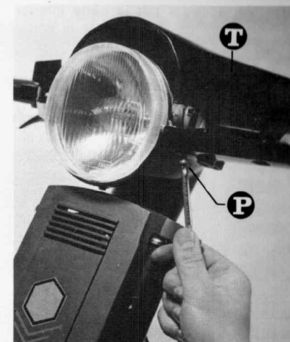
Fig. 31 Acceso lámparas proyector Desmontaje faro delantero
