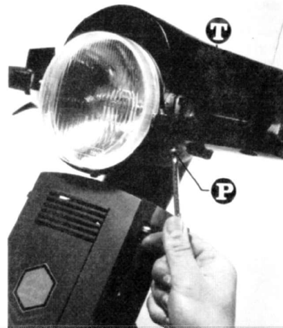
Fig. 27 Acceso lámparas proyector Desmontaje faro delantero
